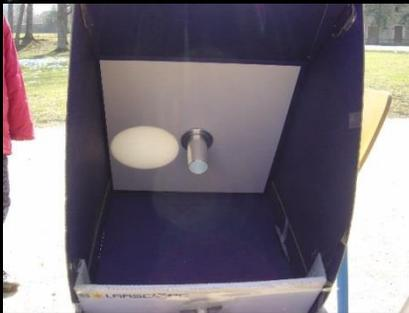
Cet appareil permet l'observation en projection du Soleil, des taches solaires, transits et éclipses grâce à la loupe qui sert d'objectif et donne une image amplifiée. Il est possible de dessiner, photographier et filmer les observations.
