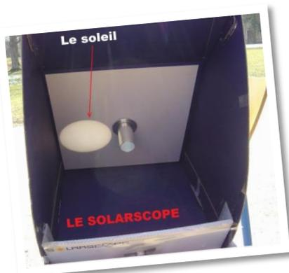
Le Solarscope (*encart 2*) est un outil d'observation solaire pratique et bon marché qui fonctionne sur le principe de la projection. Une loupe sert d'objectif et donne une image amplifiée du Soleil. En l'utilisant de manière régulière vous pouvez mettre en place un atelier suivi de l'activité solaire mais aussi mesurer sa durée de rotation. Il est parfaitement possible de réaliser des dessins de prendre des
