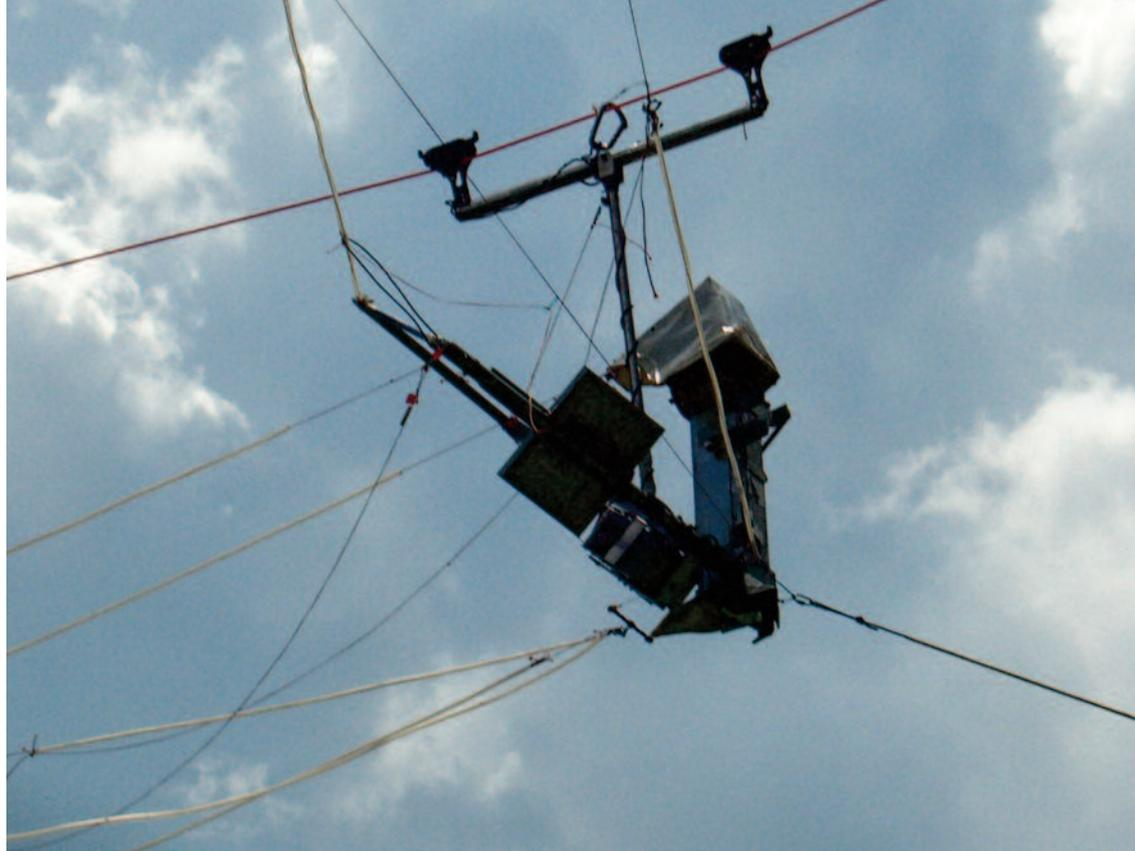
La nacelle suspendue au foyer du meta-miroir primaire. Deux roulettes lui permettent de rouler sur le câble de suspension (noir) qui traverse la vallée à 100 m de hauteur.
