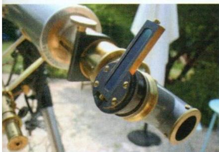
↑ UN FILTRE À DENSITÉ PROGRESSIVE monté sur un oculaire installé sur un prisme de Herschel.
